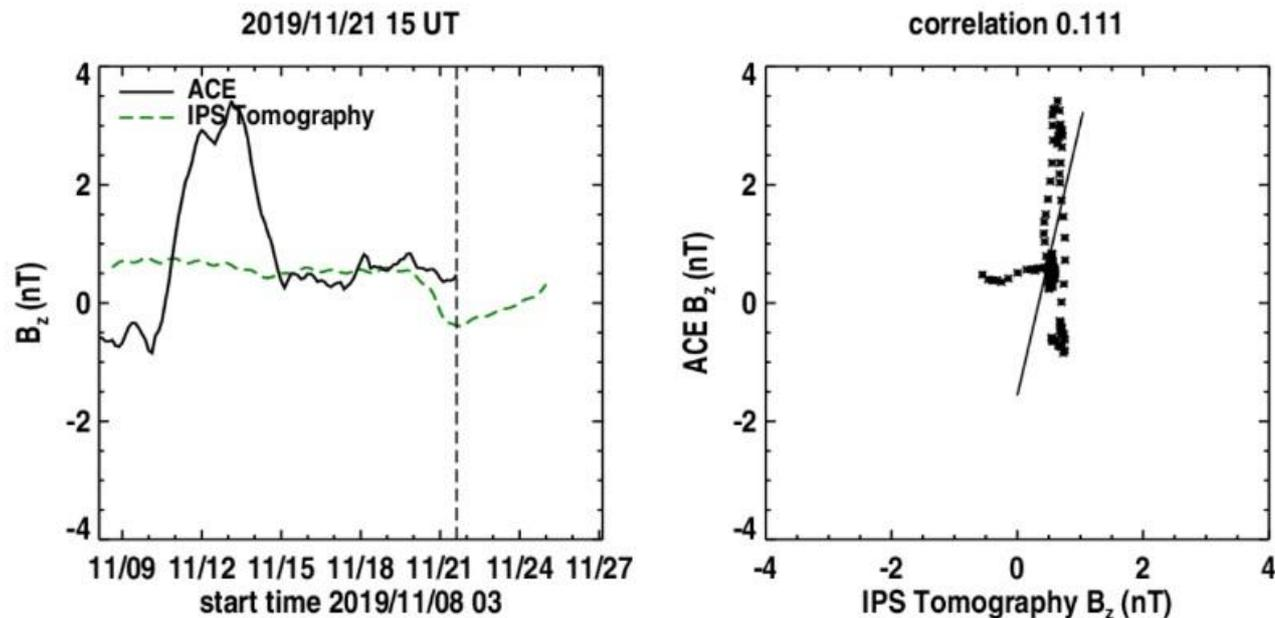
**(Izquierda)** Se pronostica una componente  $B_z$  negativa tendiendo a cero. **(Derecha)** La comparación con las observaciones del Advanced Composition Explorer (ACE) indican una correlación de 0.111 en el último pronóstico.
